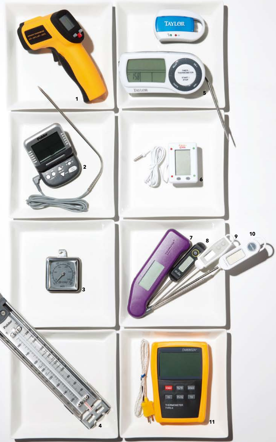
1 물체의 표면 온도를 재는 적외선 온도계. 2 케이블 탐침식 온도계. 내열 케이블을 사용하면 오븐 속 온도를 잴 수 있다. 3 오븐 속에 넣는 아날로그 온도계. 4 국이나 수프 같은 액체라면 어디든 사용할 수 있는 튀김용 온도계. 5 무선 알람(소리/진동) 장치가 딸린 탐침식 디지털 온도계. 6 냉장/냉동고용 온도계. 센서는 안에 넣고 온도계는 냉장고 표면에 붙일 수 있다. 7, 8, 9, 10 가장 기본적인 탐침식 온도계. 탐침 보호 커버가 제공된다. 11 K-타입 센서 플러그를 교체하면 다양도로 사용할 수 있는 정밀 온도계(주방에서 사용할 수 있는 탐침식 센서도 있다). 한국타이어 모터스포츠 지원 팀이 서킷 피트에서 타이어 표면 온도를 잴 때도 이렇게 생긴 온도계를 사용한다.
