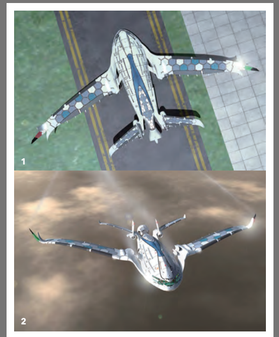
1 프로그레스 이글의 좌석수를 300석으로 제한하면 모든 승객에게 1등석 수준의 좌석과 카지노, 레스토랑, 스파 등 럭셔리한 서비스를 제공할 수 있다는 게 설계자인 오스카 비날스의 설명이다. 2 프로그레스 이글은 대기 중의 CO 2 를 포집, 탄산염 및 수산화물을 반응시켜 환경에 무해한 중탄산염으로 변환시키는 능동형 친환경 여객기다. 3 얼핏 조종석으로 보이는 6각형 앞유리는 객실 앞쪽 전망대다. 조종석은 그 위에 따로 튀어나온 부분이다.
