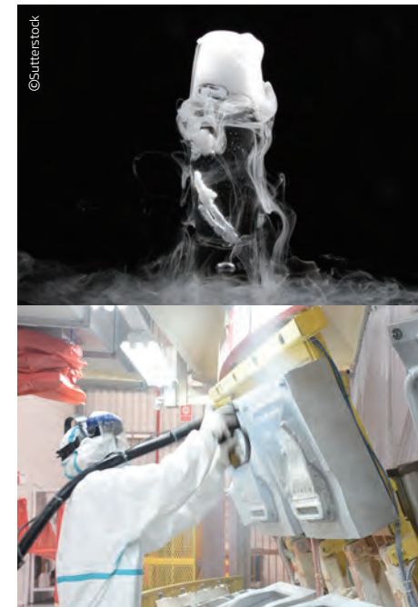
공기 중에서 기화하는 드라이아이스(위)를 미세 분말로 분쇄해 고압 분사하며 사출성형 물드를 세척하고 있다(아래).
